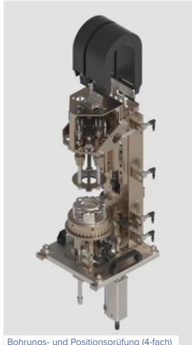
Bohrungs- und Positionsprüfung (4-fach)
