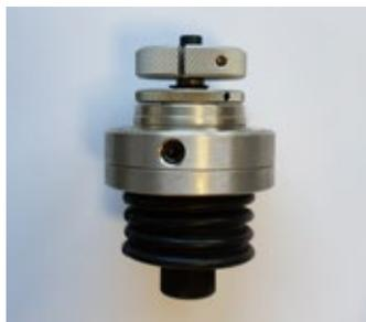
STOTZ Schwimmhalter werden unter anderem zusammen mit Bohrungsmessdornen zum Messen in Vorrichtungen eingesetzt. Aufgabe des Schwimmhalters ist es, Positionierfehler vom Messgerät zur Bohrung auszugleichen und geringe Winkelfehler vom Messgerät zur Bohrungsachse zu überbrücken.
