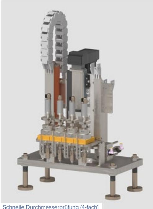
Schnelle Durchmesserprüfung (4-fach)
